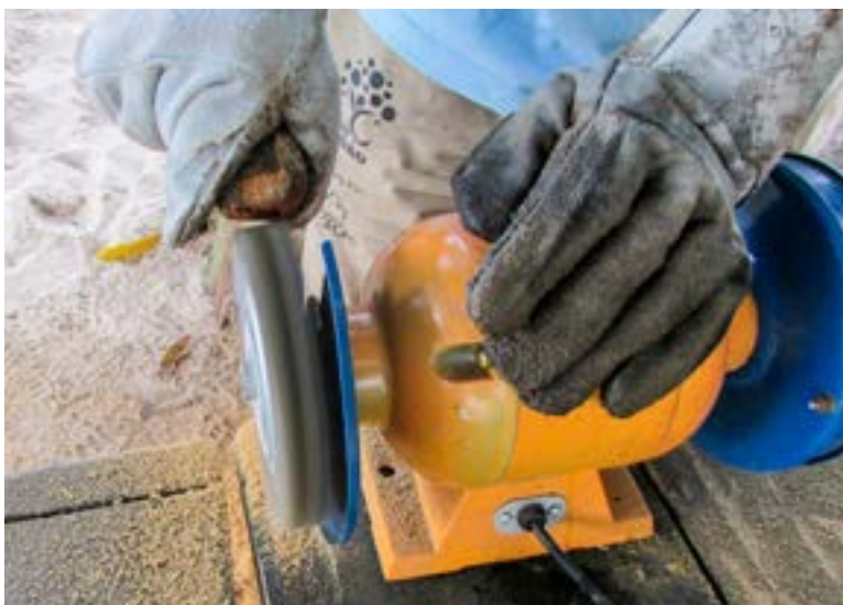
Escarificação Mecânica do excesso de polpa de sementes de Piquiá.
